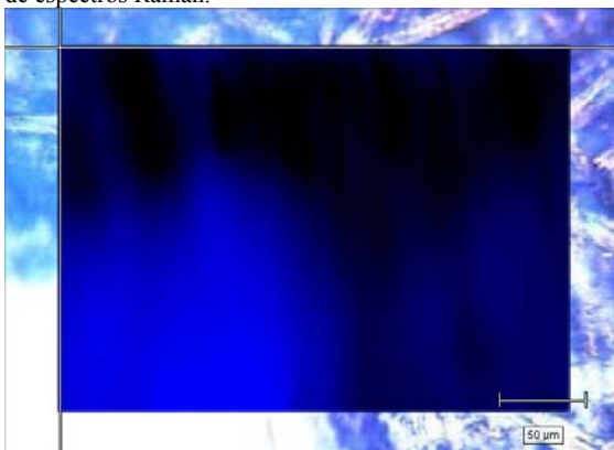
Figura 16. Principal componente da análise da correlação dos espectros Raman do mapeamento 2D com o espectro Raman da fibra do papel, em azul claro.
