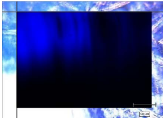
Figura 15. Principal componente da análise da correlação dos espectros Raman do mapeamento 2D com o espectro Raman da tinta da “caneta 7e” (horizontal), em azul claro.
