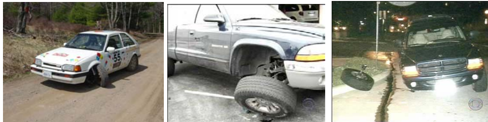
Figura 4. Queda das rodas dos veículo devido à quebra do pivô 2 .
