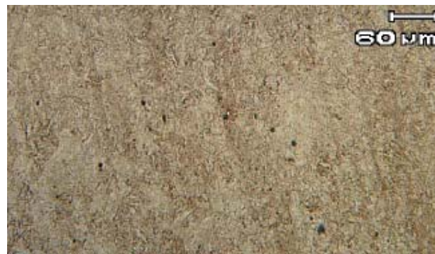
Figura 14. Micrografias mostrando microestrutura martensítica do pino.
