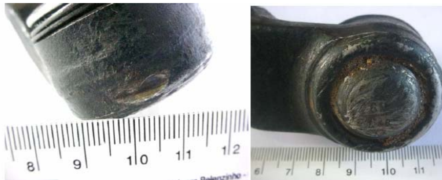
Figura 11. À esquerda, imagem mostrando marca proveniente de uma pancada na base do alojamento do pino. À direita, resquícios de areia incrustada na base do alojamento e arranhões indicando que o componente deslizou sobre o solo.
