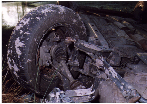
Figura 8. Detalhe do sistema de suspensão dianteiro esquerdo estava parcialmente desarticulado da roda
